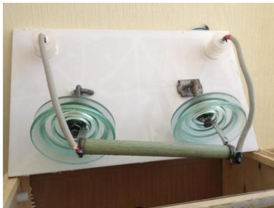
Рисунок 4 – Монтаж испытуемого образца на испытательном стенде
