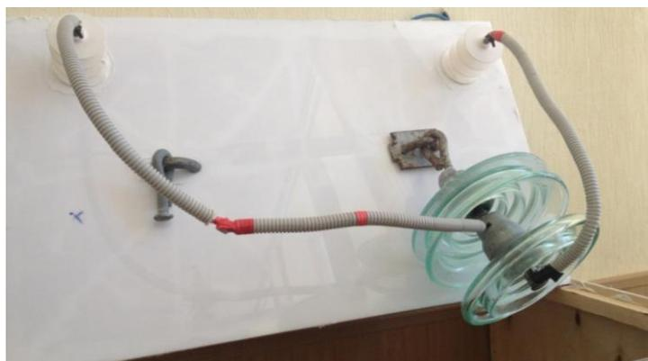
Рисунок 3.8 – Крепление изолятора ПС-70Е на испытательном стенде
