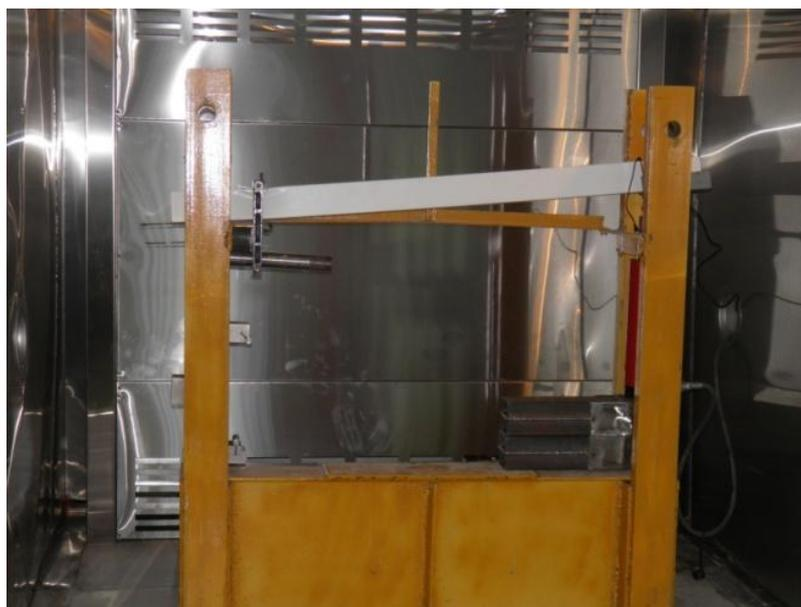
Рисунок 1.22 – ИЦ ТСЖТ стенд испытаний стеклопластикового профиля на механическую прочность, разрушение образца.
