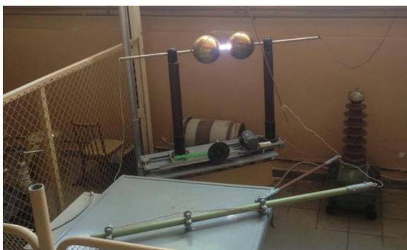
Рисунок 15 – Фрагмент испытания импульсным напряжением с фиксацией разряда
