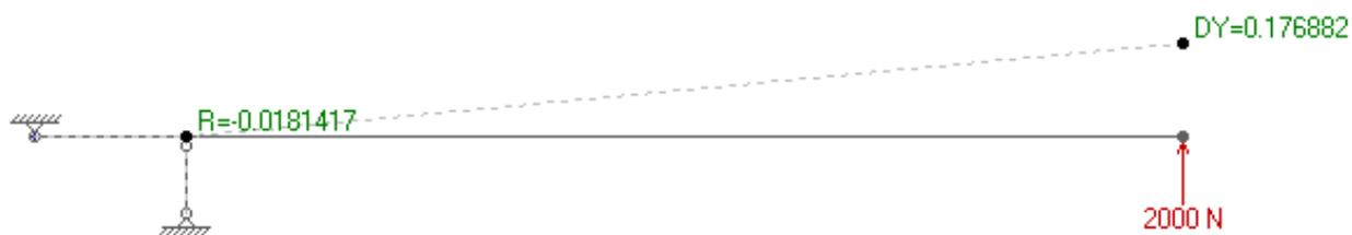
Рисунок 1.24 – Схема перемещения стеклопластикового профиля
