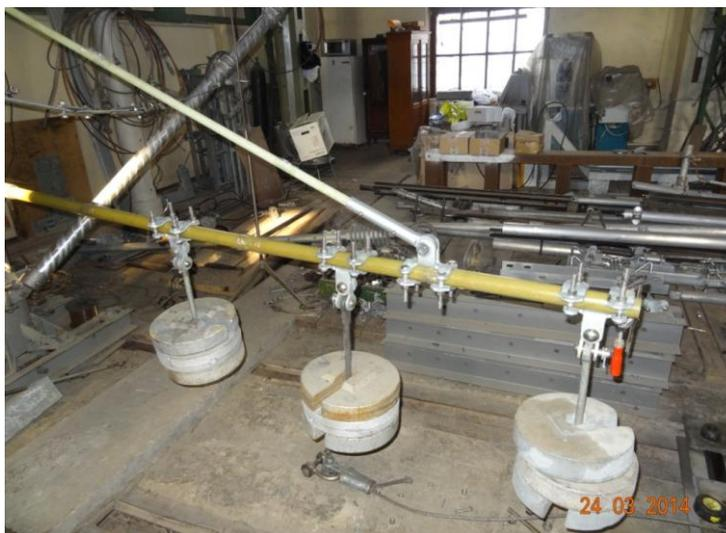
Рисунок 3.3 – Фрагмент механических испытаний кронштейна серии СИП-Т-3 в испытательном центре «ЦНИИС-ЭлЖТ» ОАО ЦНИИС
