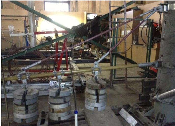
Рисунок 3.4 – Фрагмент механических испытаний полимерного кронштейна КПСИП-3 в испытательном центре «ЦНИИС-ЭлЖТ» ОАО ЦНИИС
