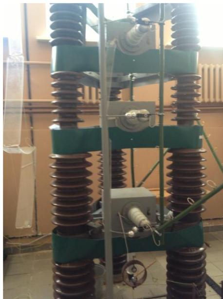
Рисунок 12 – Четырехступенчатый генератор импульсных напряжений (ГИИ)
