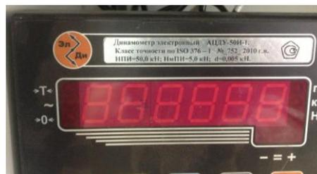
Рисунок 2 – Внешний вид динамометра АЦДУ-50И-1
