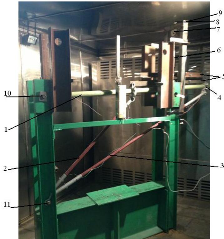
1 – траверса; 2 – тяга(1); 3 – тяга(2); 4 – узел крепления проводов; 5 – металлическая балка (уголок); 6 – стяжной зажим (талреп); 7 – динамометр; 8 – болт; 9 – опорная плита; 10 – узел крепления траверсы; 11 – узел крепления тяг
