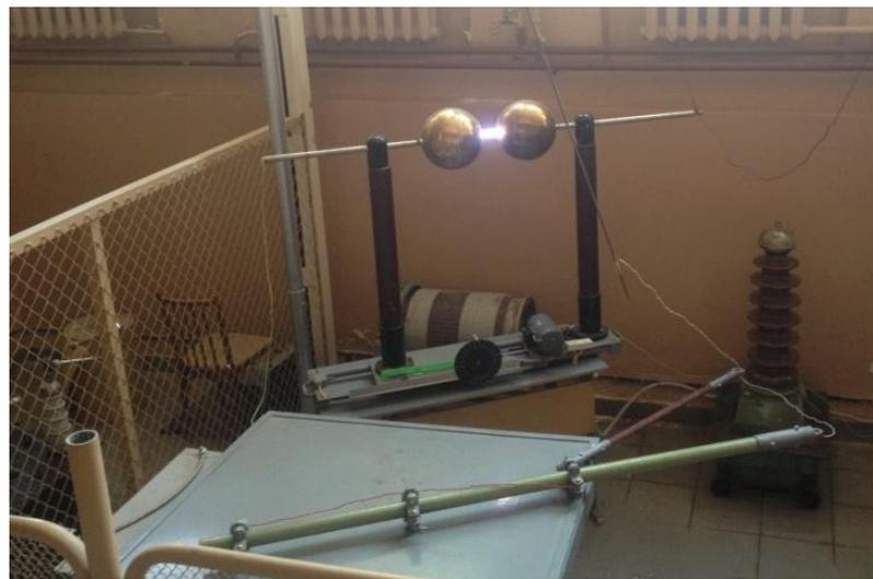
Рисунок 3.23 – Фрагмент испытания импульсным напряжением с фиксацией разряда
