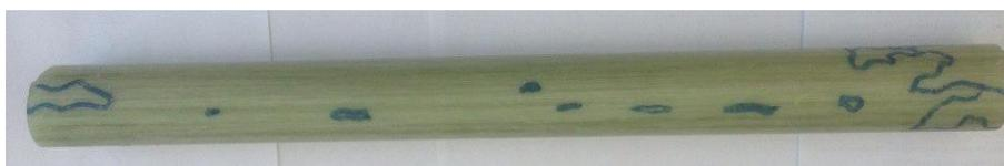
Рисунок 3.7 – Образец полимерного кронштейна с поврежденной защитной оболочкой
