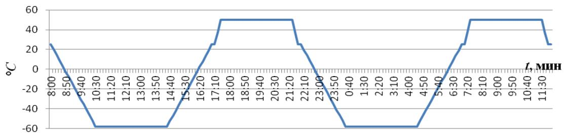
Рисунок 3.13 – Температурный цикл испытаний
